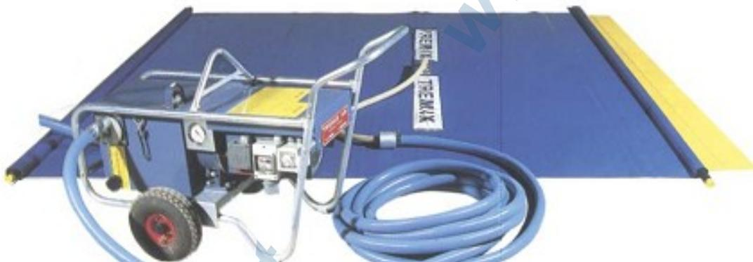
Вакуумный агрегат Р4001Е фирмы TREMIX используется в комплекте с вакуумматом ТОР для снижения содержания воды на 20-25% в свежеуложенном бетоне, что соответственно снижает водоцементное отношение и, следовательно, увеличивает прочность на сжатие и улучшает износостойкость поверхности бетона. исключается вероятность усадки бетона.
